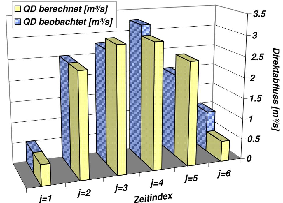
**Problem:** Zur Bestimmung der Modellparameter ( $h_i$ ) nutzt das „direkte Verfahren“ nur ein Teil der vorhandenen Informationen (hier die ersten beiden  $QD_j$ -Werte, da übrige Gleichungen weggelassen werden)
