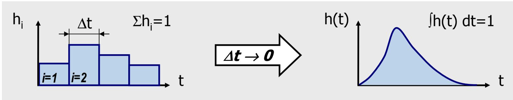
Der Übergang von der diskreten zur kontinuierlichen Form der Einheitsganglinie entspricht der Annäherung  $\Delta t \rightarrow 0$ . Das Integral der Funktion im Bereich  $t=0$  bis  $t=\infty$  ist 1.
