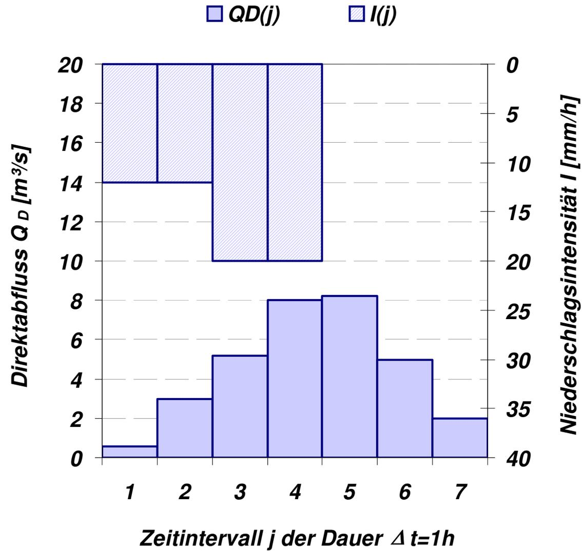
1. Schema der Niederschlags-Abfluss-Modellierung
