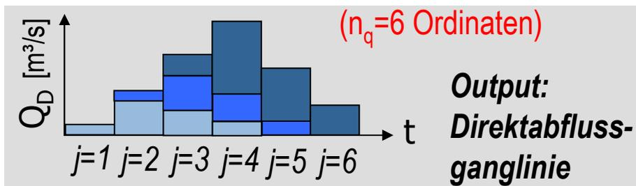
**Ziel:** Berechnen der Ganglinie  $Q_D(t)$  aus einer Ganglinie des Niederschlags  $I(t)$  mittels gegebener, diskreter Einheitsganglinie
