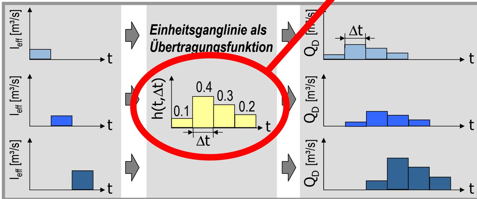
Für die Berechnung von  $Q_D(t)$  aus  $I_{\text{eff}}(t)$  muss die Einheitsganglinie bereits bekannt sein
