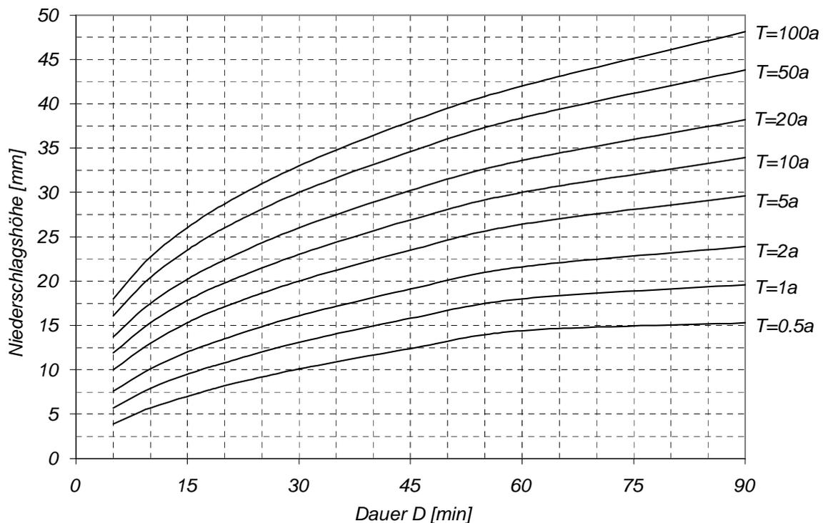
Abb. 1-9 Niederschlags-Höhen-Dauer-Häufigkeitsbeziehung für Dauerstufen von 5–90 Minuten und Jährlichkeiten von 0.5–100 Jahren.
