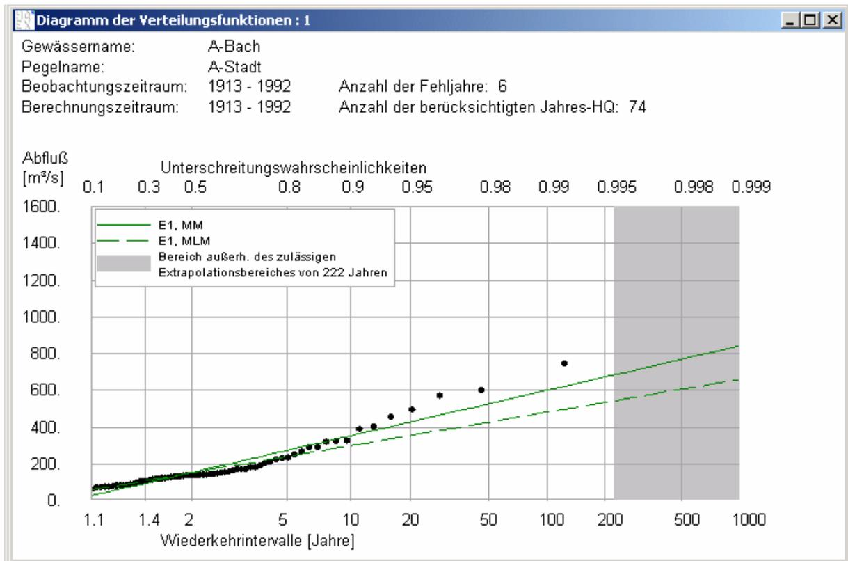
Abb. 1-5 Anpassung einer Extremwertverteilungsfunktion Typ 1 (E1) mittels Momenten-Methode (MM) und Maximum-Likelihood-Methode (MLM). [Beispieldatensatz des Programms HQ-Ex der Firma WASY]
