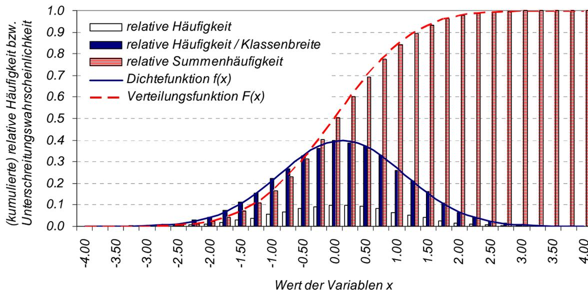
Abb. 1-1 Übergang der relativen Häufigkeit in die Dichtefunktion  $f(x)$  und der relativen Summenhäufigkeit in die Verteilungsfunktion  $F(x)$  am Beispiel einer normalverteilten Zufallsvariablen  $x$  mit dem Mittelwert  $\mu=0$  und der Standardabweichung  $\sigma=1$  (normierte Normalverteilung  $NV(\mu=0; \sigma=1)$ ). Zugrunde liegen 20000 Realisationen. Die Klassenbreite für die Darstellung der relativen Häufigkeiten beträgt 0.25.
